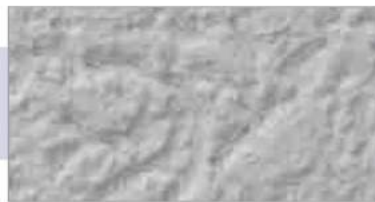
Beschichtung mit Schrumpfrissen.
